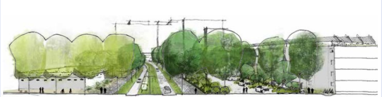
Abb. 6: Hier verschatten Straßenbäume Verkehrsflächen wie Rad- und Fußwege: Schnitt-Perspektive durch den Straßenraum mit ergänztem Baumbestand, begrünter Straßenbahntrasse und entsiegelter Parkplatzanlage, Leitfaden für klimaorientierte Kommunen in Bayern. 8
